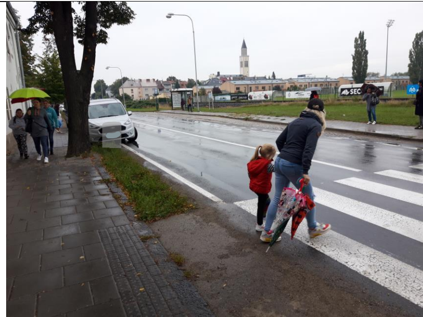
Obr. 7 Zastavování vozidel přivázejících žáky na Svatoplukově u branky ke škole. Auta stojí před přechodem pro chodce a vytváří překážku v rozhledu. Foto: Z. Sperat
