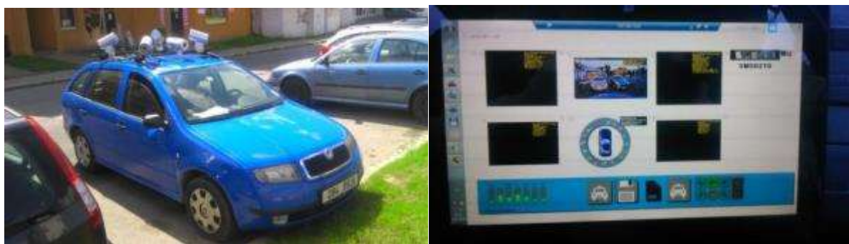
Obrázek 7: Vozidlo vybavené pro automatizovanou kontrolu parkujících vozidel a jeho ovládací software.
